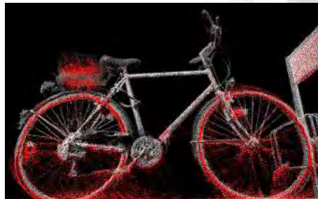
автоматический выбор „недействительных“ точек, используя информацию об атрибуте отклонения формы импульса
